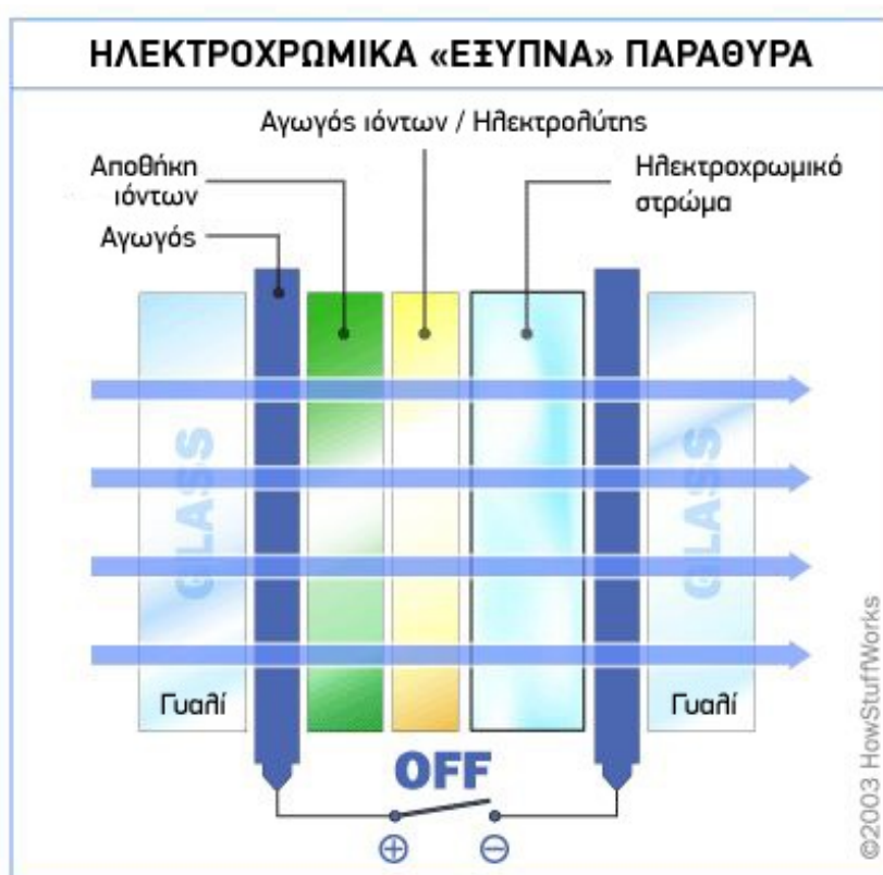
82. Ηλεκτροχρωμικοί υαλοπίνακες (πηγή: http://news.pathfinder.gr/eco-science/technologein/1330887.html )
