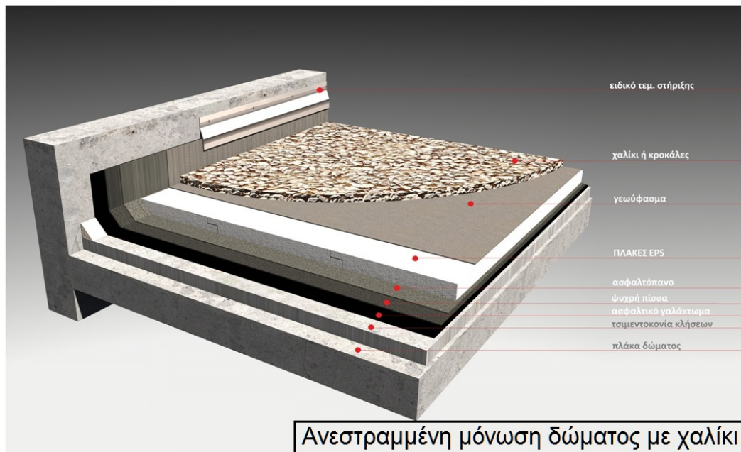
65. Ανεστραμμένη μόνωση δώματος με χαλίκι (πηγή: http://www.ergatex.gr/insulation/roof/anestrammeni_monosi_domatos/ )
