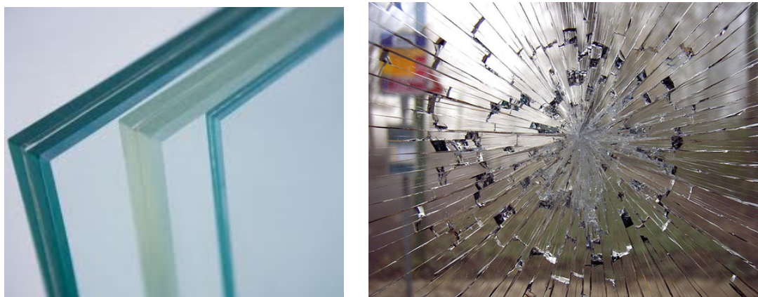
80. Triplex ή laminated υαλοπίνακες (πηγή: http://www.haufen.gr/frontend/article.php?aid=147&cid=49 )
