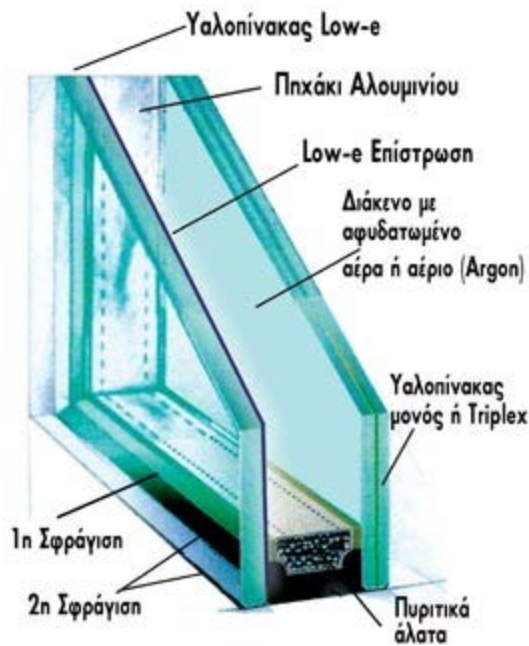
78. Υαλοπίνακας low-e (πηγή: http://www.ktizontastomellon.gr/bibliothiki/Yalopinakes/Exeliksh.php )
