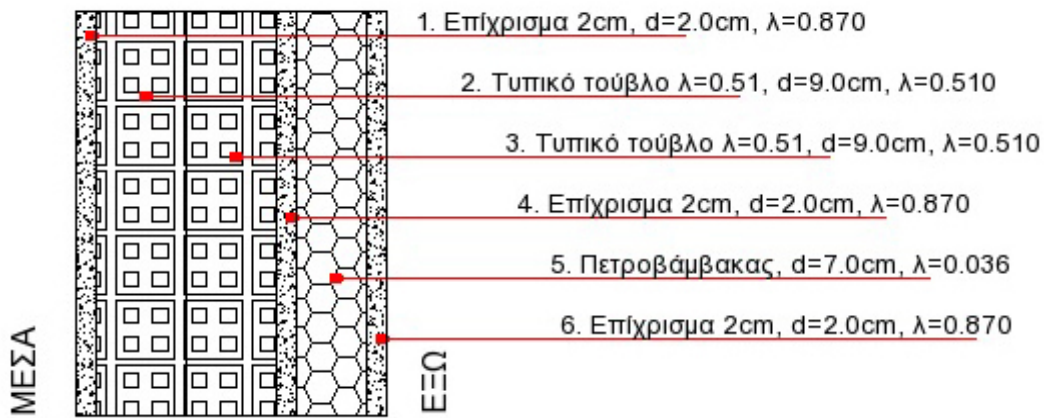
93. Τομή τοίχου με εξωτερική θερμομόνωση (πηγή: http://lakenak.sourceforge.net/demo/domika_kelyfos.php?page=1 )
