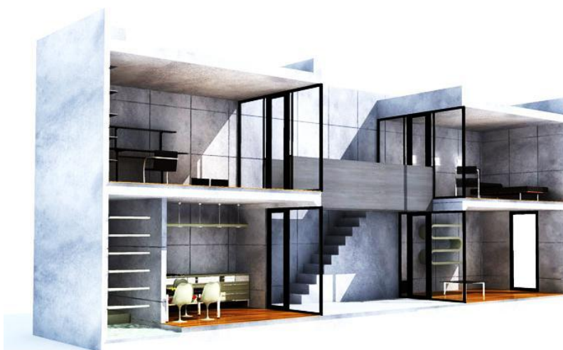
Εικ. 4.7. Tadao Ando - Azuma House (1976). Οι χώροι του σπιτιού φωτίζονται και αερίζονται μέσω του αιθρίου.
