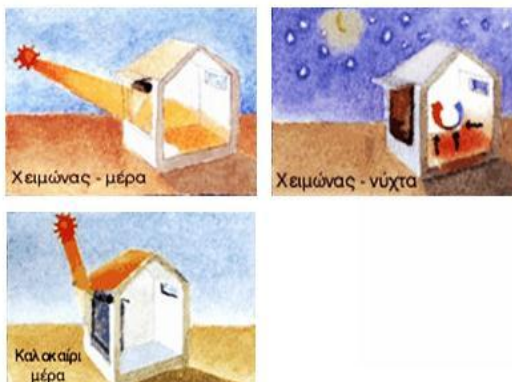
Εικ. 1.4. Νότια ανοίγματα δέχονται περισσότερη ηλιακή ακτινοβολία το χειμώνα και με το κατάλληλο σκίαστρο λιγότερη το καλοκαίρι.
