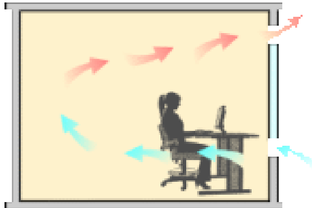
Εικόνα 2.14, Πορεία ροής εξαερισμού με χρήση διπλού ανοίγματος (Πηγή: www.gaia.lbl.gov )
