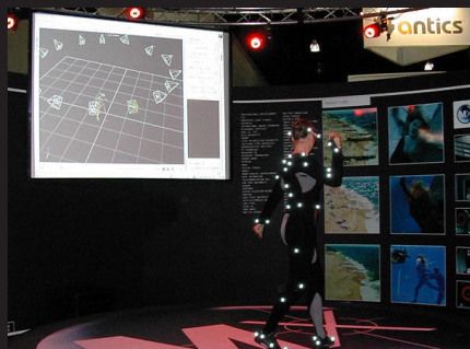
81. Χορεύτρια με κουστούμι για οπτικό σύστημα αιχμαλώτισης κίνησης
