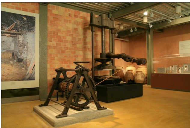
Εικόνα 2.24. Πρέσα και βαρούλκο ζωκίνητου ελαιοτριβείου από το Δράγανο Λευκάδας, 20 ος αιώνας. (Πηγή: ιστοσελίδα http://www.flickr.com/photos/27729104@N07/6713668245/ )
