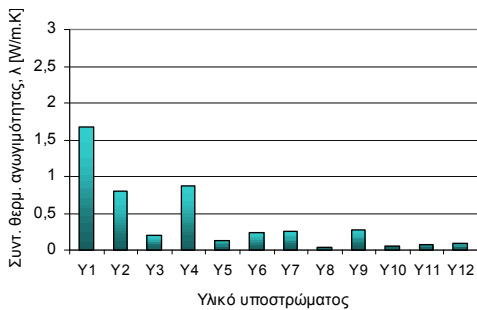
Σχήμα 4. Τιμές του συντελεστή θερμικής αγωγιμότητας υλικών υποστρώματος.
