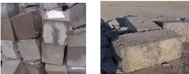
Σχήμα 1: Θραυσμένα δοκίμια (αριστερά) και στοιχεία σκυροδέματος (δεξιά) για την παραγωγή αδρανών ανομοιογενούς και ομοιογενούς προέλευσης αντίστοιχα
